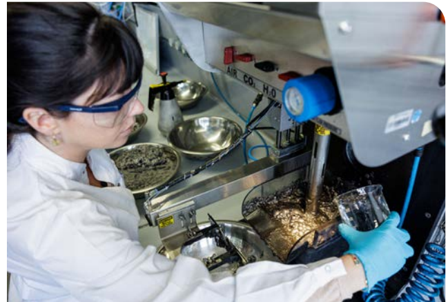
Dr. Anna Vanderbruggen an der Schaumflotations-Anlage beim Prozess der Graphit-Rückgewinnung
